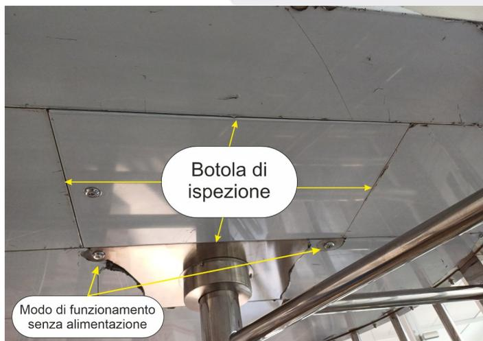
Le due chiavi laterali permettono di modificare il funzionamento del tornello in caso di mancanza di tensione di alimentazione, con una chiave dedicata per ciascun senso di rotazione.
