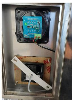
10) Alloggiare l'eventuale centralina per il controllo accessi nel vano all'interno del coperchio superiore, e collegare i lettori.
