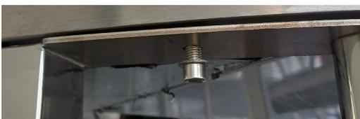
4) Una persona inserisce l'anello di collegamento nell'albero superiore spingendolo in alto (1), lo tiene fermo in quella posizione, quindi solleva il coperchio (2) per permettere il comodo passaggio del rotore.
