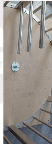
3) Appoggiare il coperchio superiore e inserire solamente le due viti di fissaggio dal lato interno, senza avvitare completamente. Questo permetterà di sollevare il coperchio in modo da inserire il rotore in maniera più agevole. Il lato del coperchio con la botola di ispezione va rivolto verso l'interno.
